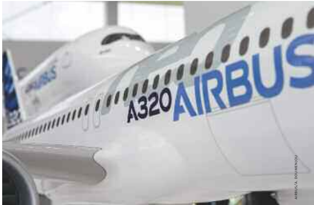
L'A320 neo – acronyme pour new engine option – réduit la consommation de carburant de 15 %.
